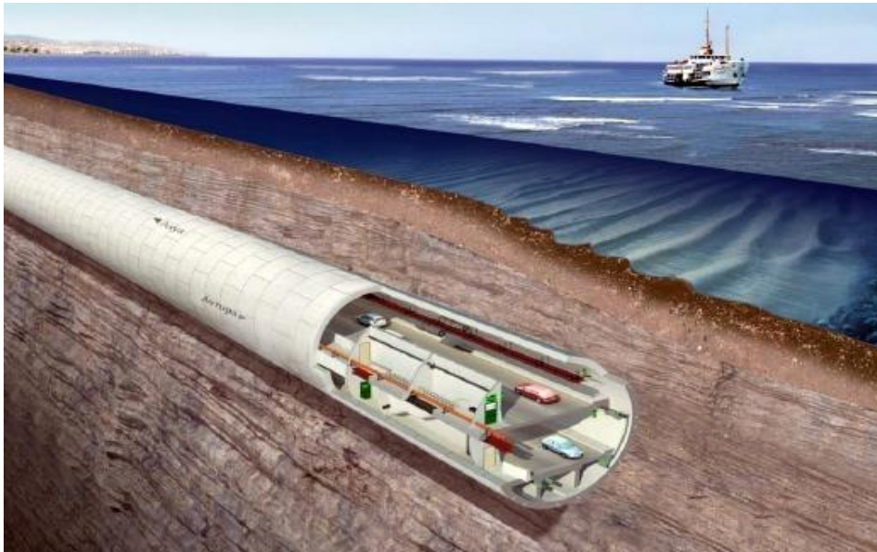
Şekil 13. Projenin denizin altından geçecek olan ana tünel kesiti
