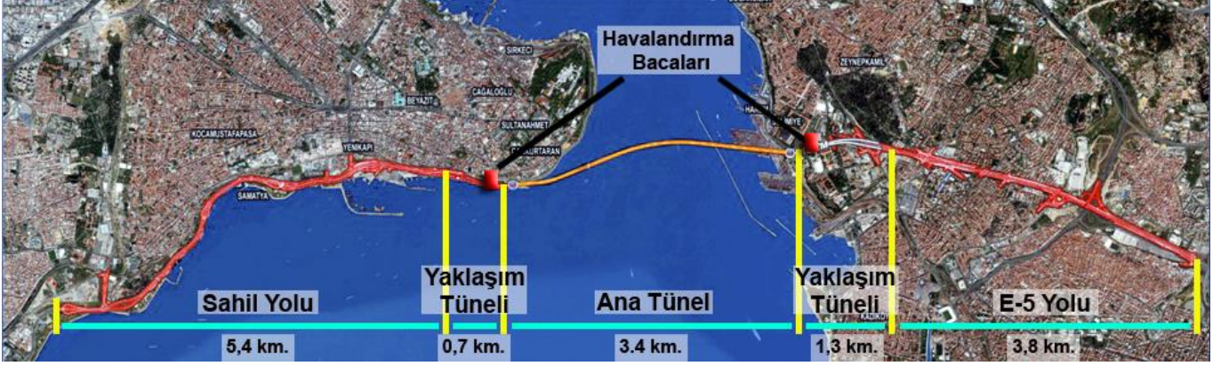
Şekil 12. Projenin etapları ve havalandırma bacalarının konumu
